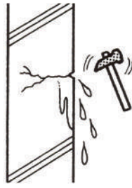
漏水部の確認
