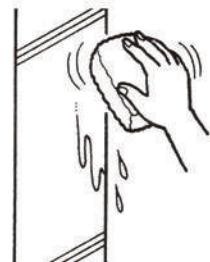
スポンジ等で水を拭き取り、下地清掃
