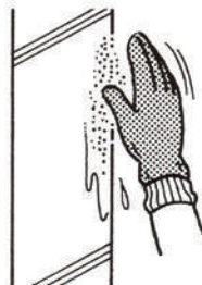
ホーウン止水を粉末のままシミ出し箇所に擦り込む
